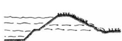
*Rotta per sifonamento:* infiltrazione d'acqua all'interno del corpo arginale con fuoriuscita sul fianco esterno.
