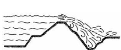
*Rotta per erosione:* parziale demolizione del lato interno di un argine per erosione al piede esercitata dalla corrente fluviale
